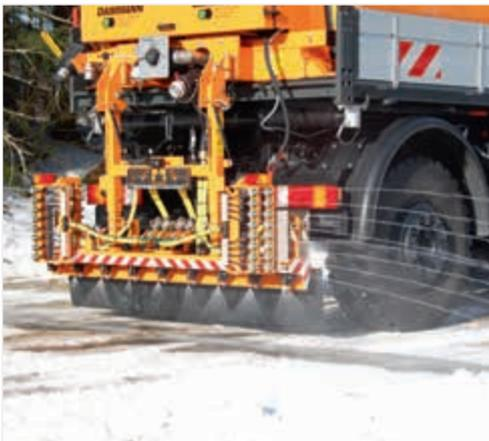
Die Enteisung von Verkehrsflächen (z. B. Flughäfen, Straßen) mit Sole stellt ein effektives und wirtschaftliches Verfahren dar. Eingesetzt werden abdriftarme ID-Düsen in Kombination mit VarioSelect zur variablen Düsensteuerung, um bei wechselnden Fahrgeschwindigkeiten die Aufwandmenge konstant zu halten.
