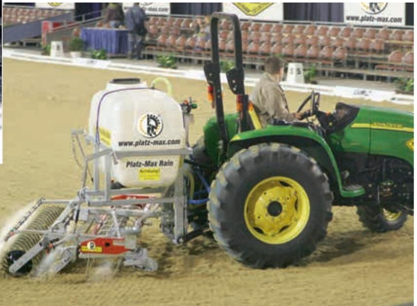
Reitboden-Befeuchtung. Insgesamt drei Düsenreihen der Air-Injektor Düse ID sorgen in Verbindung mit Bodenstriegel, Krümlerwalze und Glättzscheibe für optimal durchfeuchteten Reitboden.
