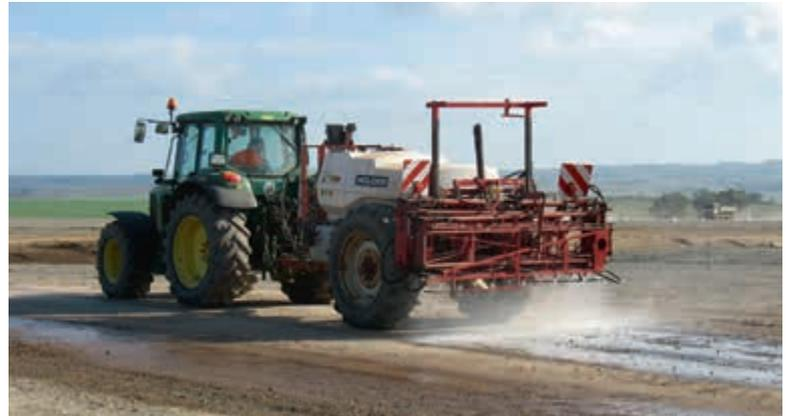
Staubbindung auf Verkehrsflächen mit ID- und FD-Düsen
