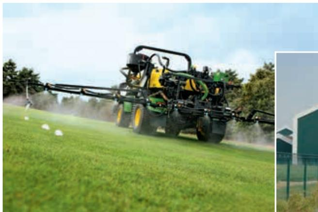
Abdriftarme Applikation auf Golfplätzen mit Air-Injektor Flachstrahldüsen ID, IDK, IDTA und IDKT
