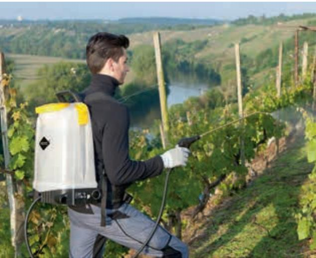
Abdriftarme Düsen, z. B. IDK, bieten optimalen Anwenderschutz bei der Schädlingsbekämpfung an Gehölzen
